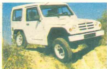
«Оверланд-А3» (Франция). Характерная особенность этой очень короткой [3460 мм] машины, предназначенной прежде всего для военных, — сдвинутые назад двигатель и радиатор. Снаряженная масса — 1185 кг. Дизельный двигатель «Пежо» мощностью 64 л. с./47 кВт. Скорость — 115 км/ч.
